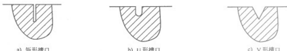
图 1 槽口的断面形状
